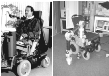
ภาพที่ 2: แขนกลที่ติดตั้งบนรถเข็นคนพิการ [7], [9]
