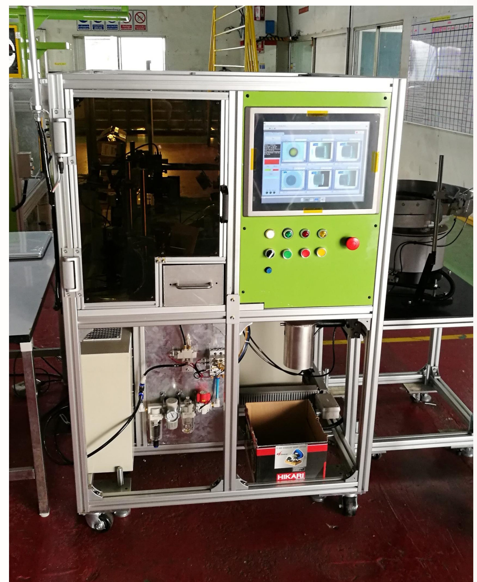
รูปที่ 2 เครื่องตรวจสอบคุณภาพและคัดแยกชิ้นงานแบบอัตโนมัติ
