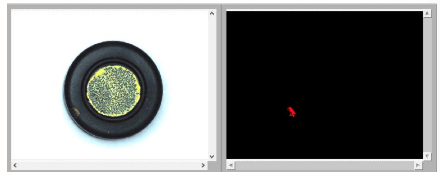
รูปที่ 1 ผลการตรวจสอบชิ้นงานที่ไม่ผ่านคุณภาพ
