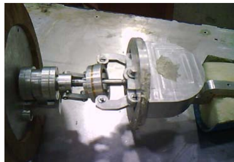
รูปที่ 1 กลไกภายในของหุ่นยนต์ปลา
