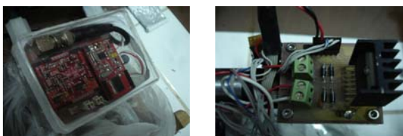
รูปที่ 10 a) กล้องควบคุม b) บอร์ดขับดีซีมอเตอร์
