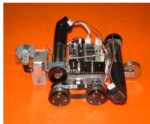
รูปที่ 2 ลักษณะและรายละเอียดชิ้นส่วนของหุ่นยนต์ตรวจสอบความหนาของถังบรรจุน้ำมันปิโตรเลียม โดยใช้อัลตราโซนิก
