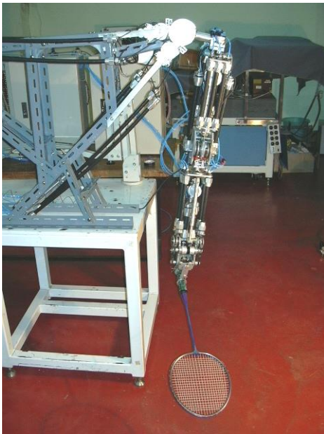
รูปที่ 1 แขนหุ่นยนต์ 7 ระดับขั้นความเสรี
