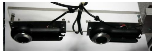
รูปแสดงกล้อง 2 ตัวสำหรับทำสเตอริโอวิชัน
