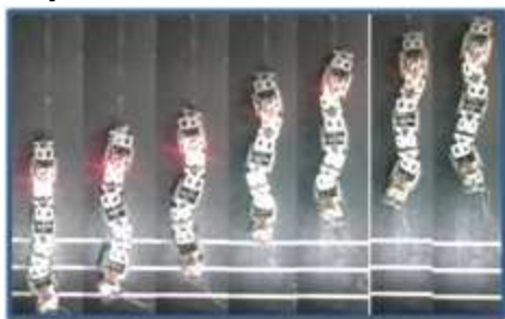
รูปที่ 9 แสดงการเคลื่อนที่ active wheel snake robot locomotion
