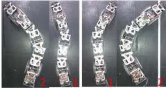
รูปที่ 5 แสดงลำดับการทำงานของหุ่นยนต์ในการเลี้ยวซ้ายและขวา
