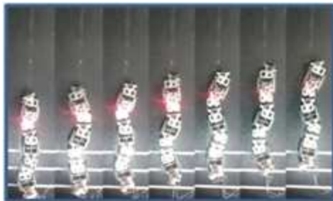
รูปที่ 8 แสดงการเคลื่อนที่แบบเซอร์เพนไทน์
