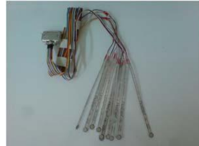
รูปที่ 6 แสดง Force sensor สำหรับวัดแรงในเท้าเทียม
