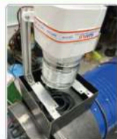
พัดลมสำหรับพาลมร้อนจากฮีตเตอร์เข้าสู่ภายในถังหมุน
