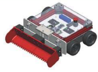
MOBILE ROBOT ที่ตัดเชื้อเพลิงในการกำจัดเชื้อเพลิงออกจากแนวกันไฟโดยสามารถปรับระดับของเกียร์เชื้อเพลิงตามพื้นผิวของสภาพแวดล้อมได้ โดยสามารถควบคุมการเคลื่อนผ่านจอยบังคับไร้สายเพื่อลดแรงงานที่ใช้ในการสร้างแนวกันไฟ
